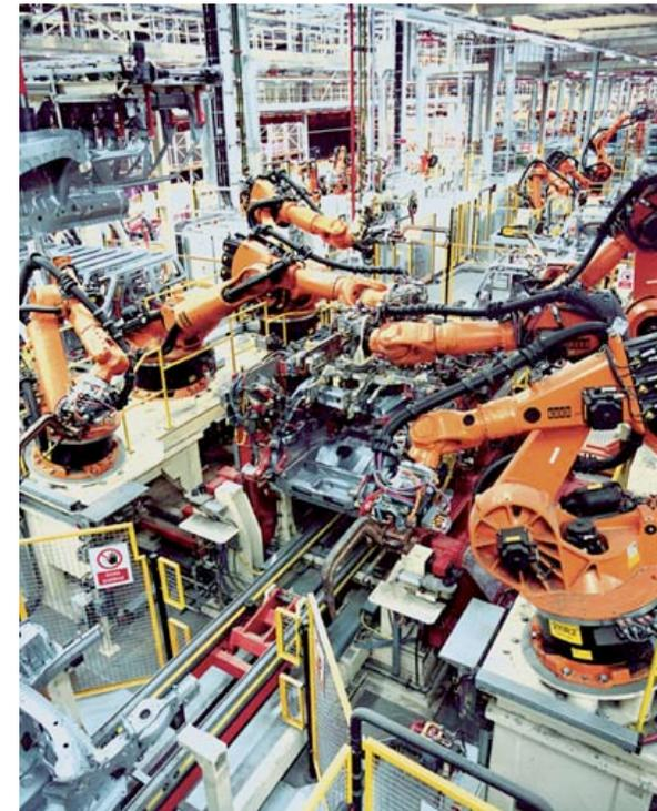
Bild: Wikipedia, KUKA Schweißanlagen
